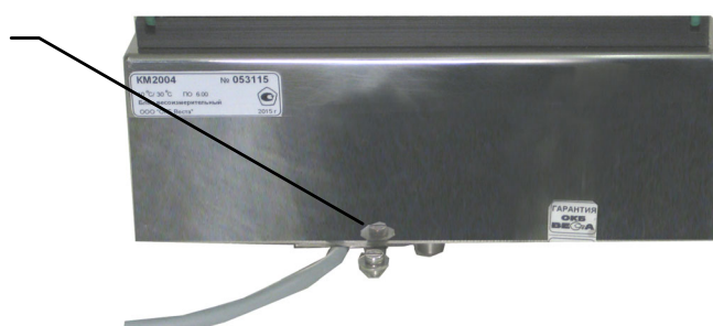
Рисунок 5 – Заземление компаратора
